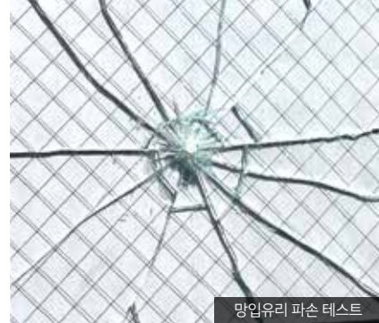
망입유리 파손 테스트
