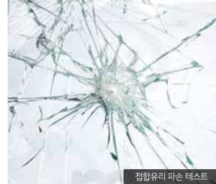
접합유리 파손 테스트
